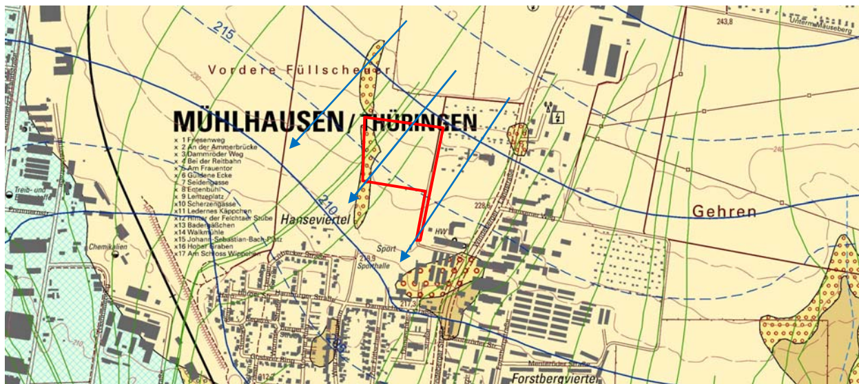
Abbildung 2: Karte der Grundwassergleichen mit Grundwasserfließrichtung [U7]
